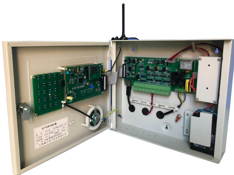
图 3 传输装置的内部结构图
