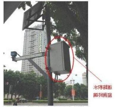
仪表采用大容量锂电池，为产品提供稳定、可靠的电源，使之安全运行 1 年以上。自主研发的低功耗系统，不但可以通过液晶屏为用户提供现场数据，而且还可通过无线模块上传数据，甚至把数据嫁接到用户自己的云平台，强大的控制算法使仪表具有工作模式自动切换、压力波动实时告警，一键唤醒等实用功能。
