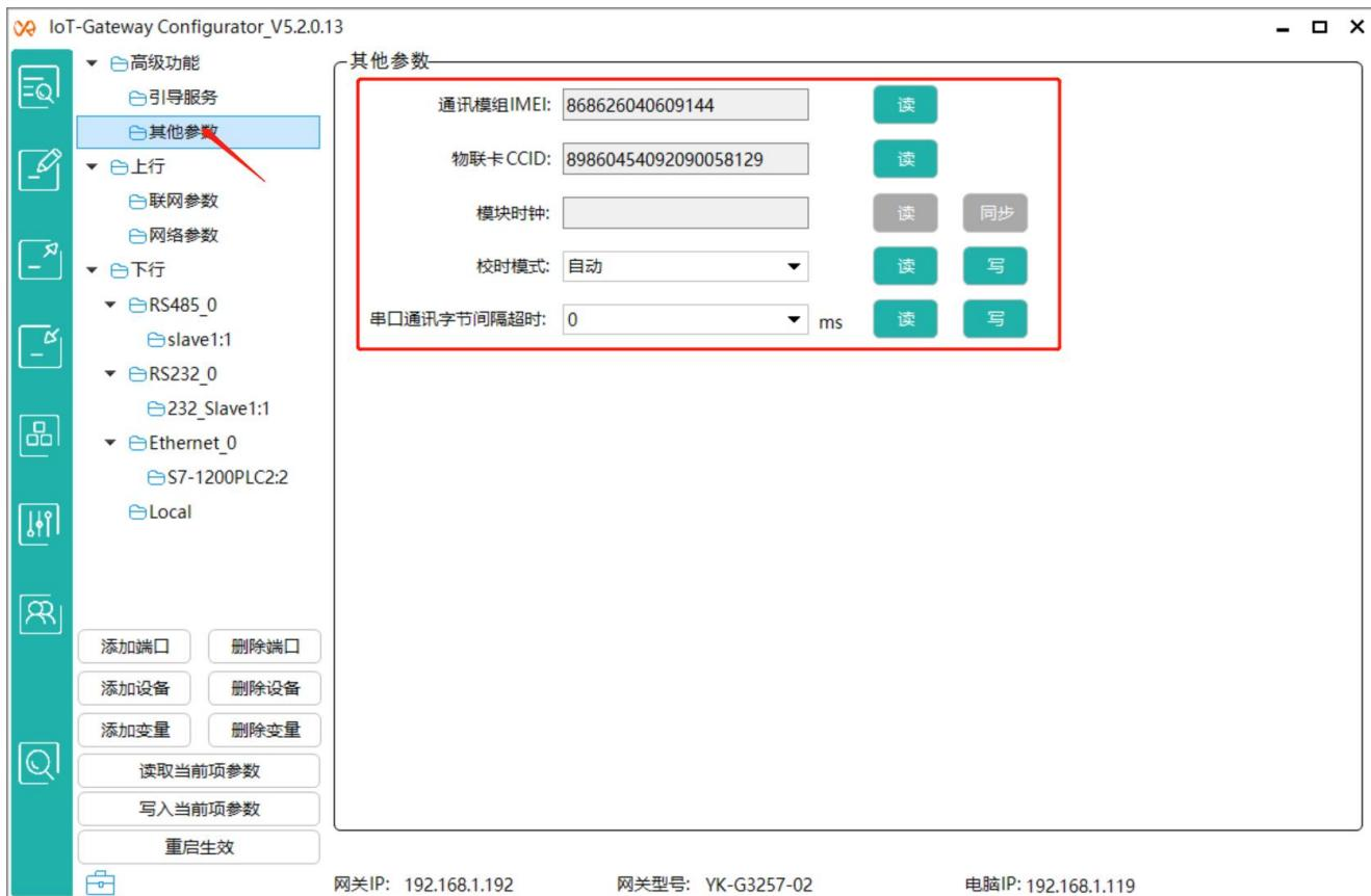
配置软件可以读取网关的 IMEI, 物联网的 CCID 等参数 (用户也可以通过远程下发查询指令查询相应的数据, 参照相应的说明) ;
