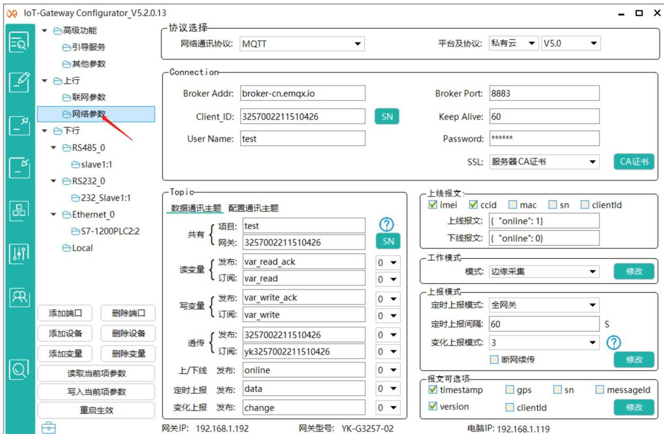
2.8.1 网络通讯协议支持 MQTT、TCP、HTTP 等，平台支持私有云、阿里云、华为云、腾讯、百度云等平台，通讯协议支持透传、Link\_V4.0、Link\_V5.0、阿里云 alink、华为 IoTDA 等。
