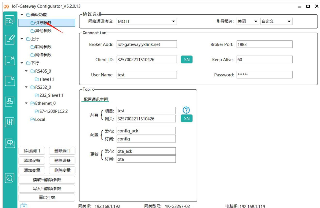
引导服务的应用场景为安装网关时还没有正式服务器的相关参数, 此时可以通过引导服务器(需支持MQTT通讯协议)对网关进行远程配置, 当网关启用了引导服务时的网关运行流程如下图:
