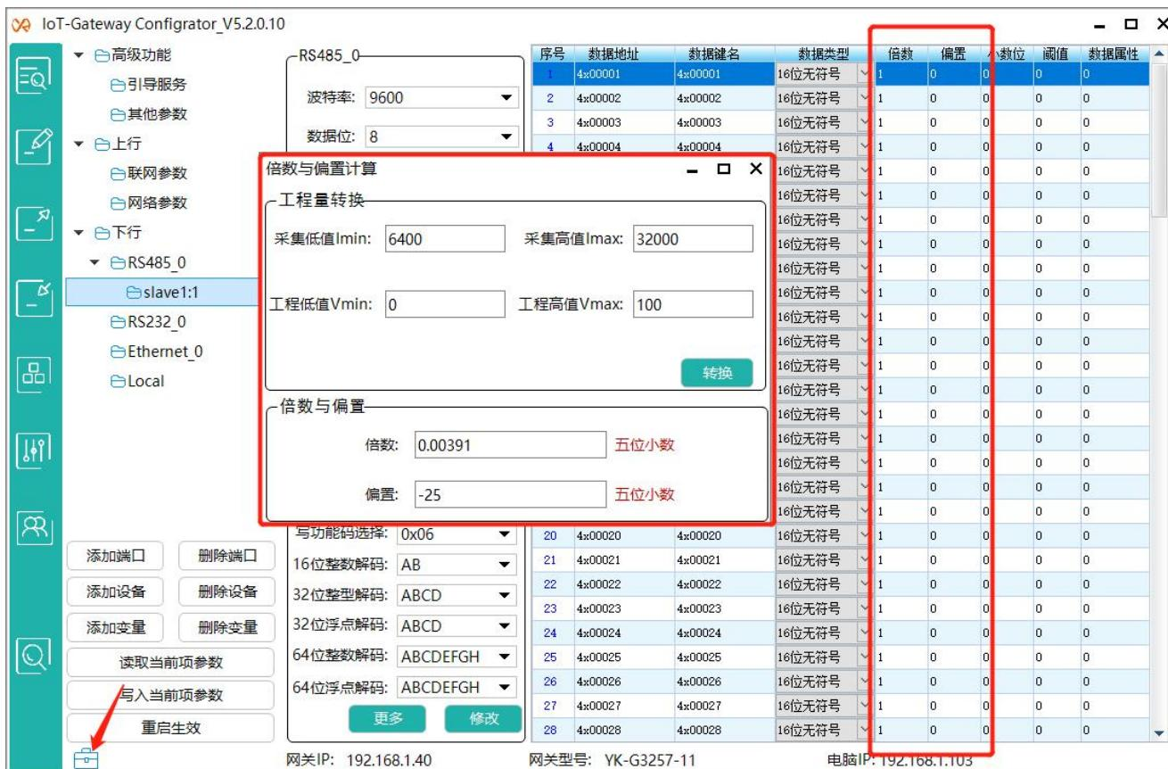
**小数位** 浮点型或做工程值转换的变量可以对其的小数位进行限制，上报给服务器的变量的
