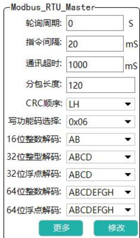
通讯超时 (Response Timeout) 单位为 mS, 即模块发出轮询指令后, 等待的最长时间, 若下位机不返回数据, 模块将跳过, 执行下一条指令;
