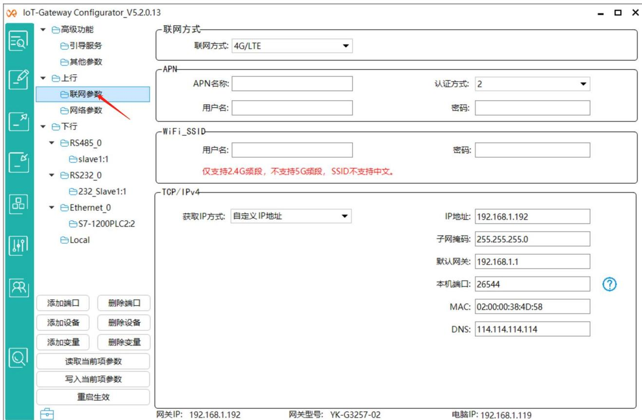
Ethernet 接入时模块获取 IP 方式，模块支持自定义 IP 与 DHCP 自动获取 IP，自动获取 (DHCP) IP 时网关须接入路由器。自定义 IP 地址时，根据实际网关所在网络的网段手动填写，当用网口直连或通过交换机仅接入网络（无路由器）时，只能采用自定义 IP 地址；
